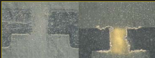
Abb. 2: Querschliff durch eine 300 µm-Durchkontaktierung in 100facher Vergrößerung vor und nach der Metallisierung.
