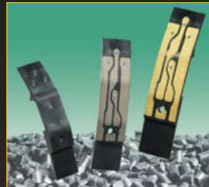
Abb. 1: Mit dem LDS-Verfahren gefertigtes Teil.
