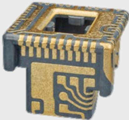
Abbildung 1: In LDS-Technologie gefertigter Sensorträger für eine Grossbildkamera
