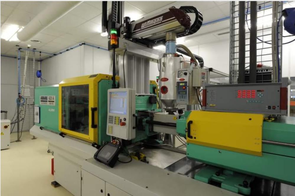
Abbildung 6: Spritzgussmaschine zur Herstellung der MID-Basissubstrate
