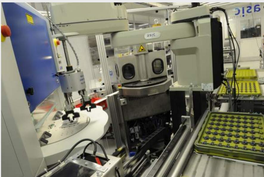
Abbildung 3: Laseranlage zur Strukturierung der Substrate mit anschließender Reinigung
